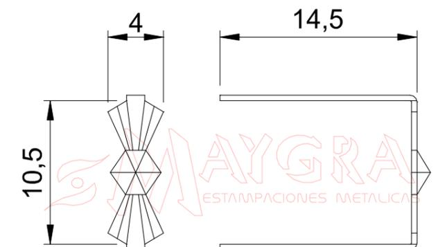
**WERKSTOFF: STAHL**     **DICKE: 0,4 mm**
