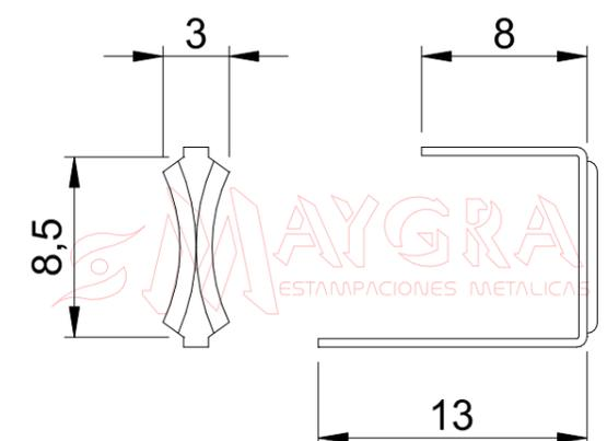
**WERKSTOFF: STAHL**     **DICKE: 0,4 mm**
